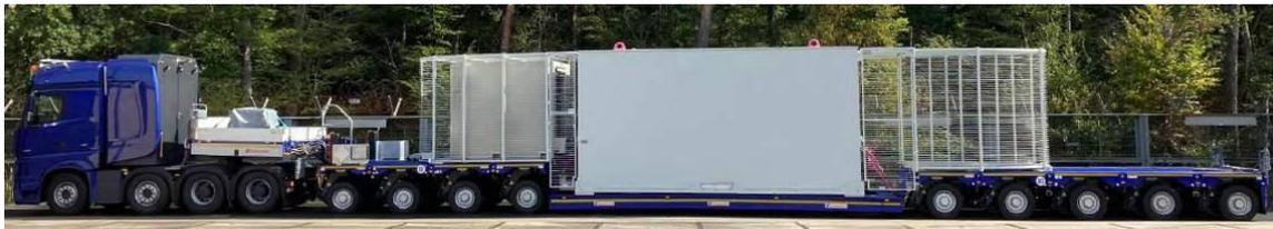
**Abbildung 1: SEWD: Transportkonfiguration, Zugmaschine 4-achsig, mit Trailer, 9-achsig (Gesamtmasse: ca. 129,00 Mg, Fahrzeuglänge: ca. 29,20 m, Fahrzeugbreite: ca. 3,00 m) (JEN 2024a)**
